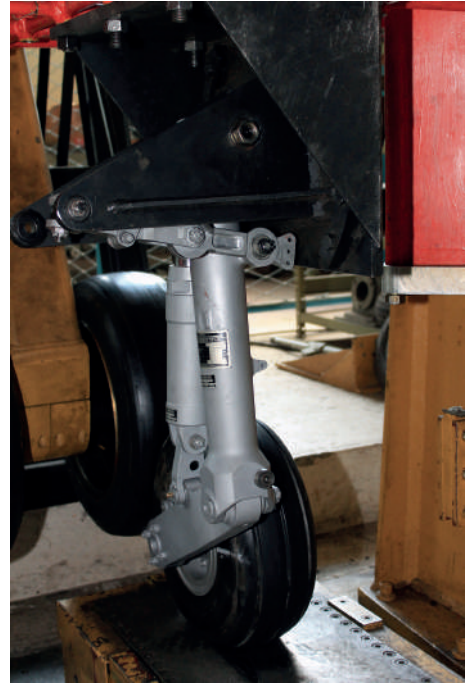
Slika 5.4 - Noga stajnog trapa pre i posle bacanja
