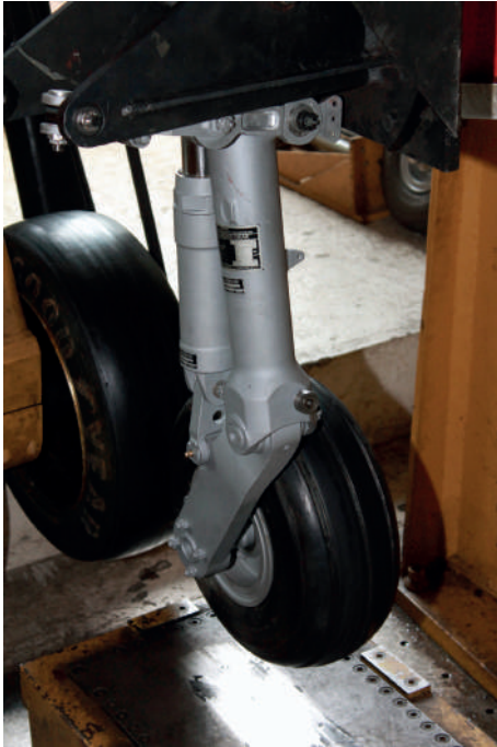
Slika 5.4 - Noga stajnog trapa pre i posle bacanja
