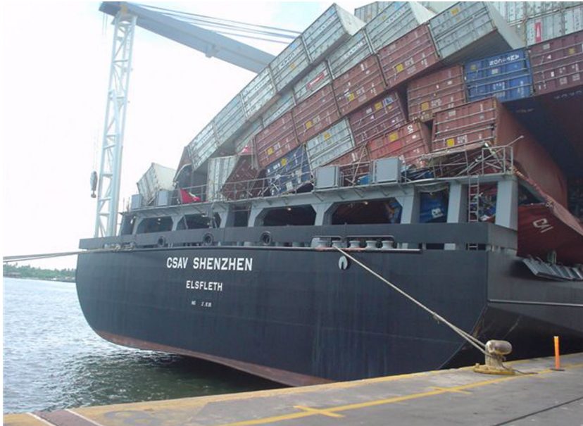
Slika 4.69. Kontejnerski brod u luci, nakon što je iskusio parametarsku rezonanciju. Uočiti široku krmu, koje obezbeđuju smeštaj velikog broja kontejnera na palubi broda.
