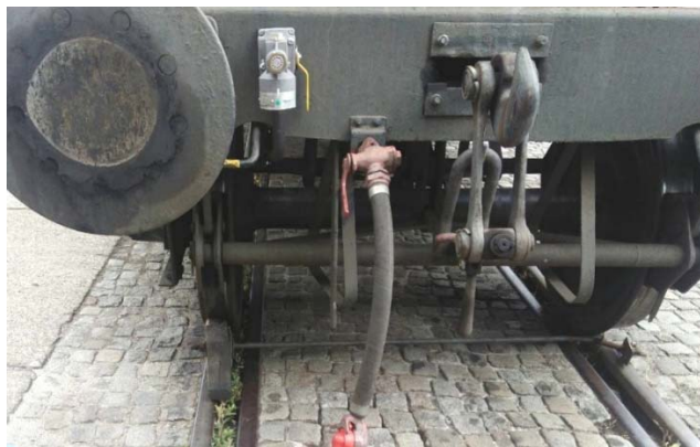
Slika 3.32 Detektor iskliznuća na vagonu
