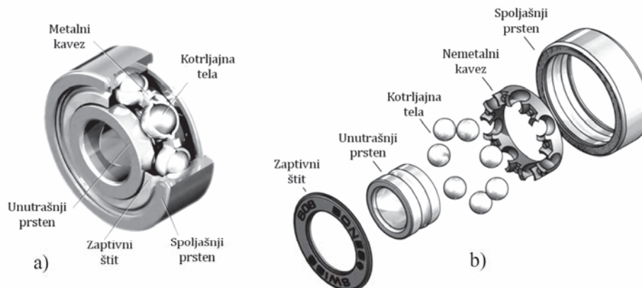
Slika 4-8 Delovi kotrljajnog kugličnog ležaja a) sa metalnim kavezom i b) sa nemetalnim kavezom (zaptivenim samo s jedne strane)
