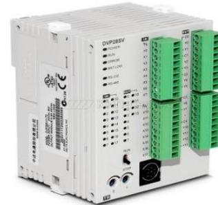
Figure 2. PLC delta DVP28SV11T PLC
