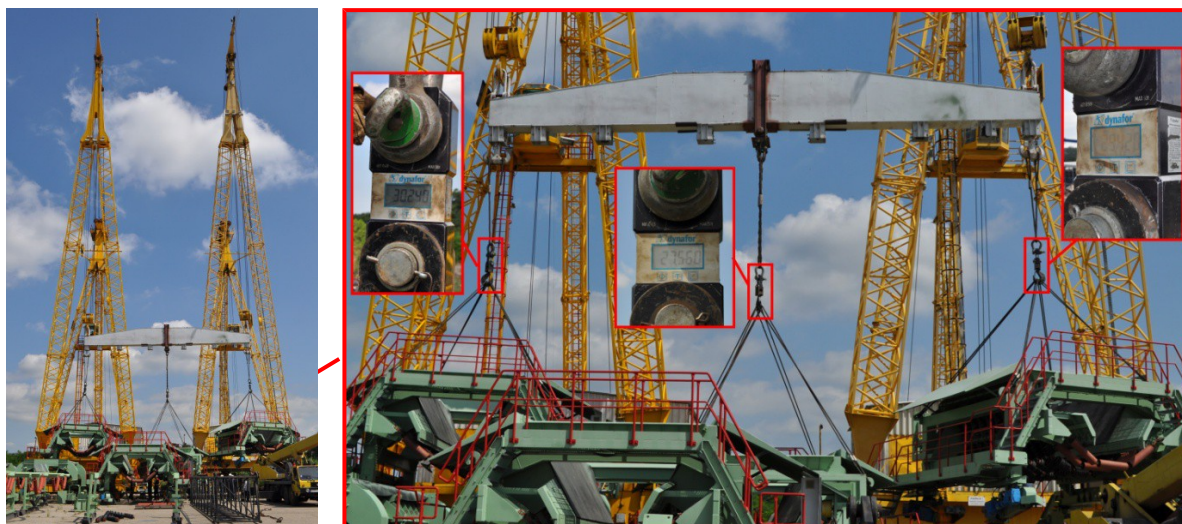
Слика 9: Испитивање помоћног подизног средства - траверзе носивости 90 t
