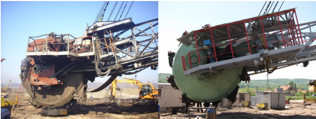
(а) (б) Слика 3: Глава стреле ротора багера SchRs 350: (а) пре реконструкције; (б) после реконструкције
